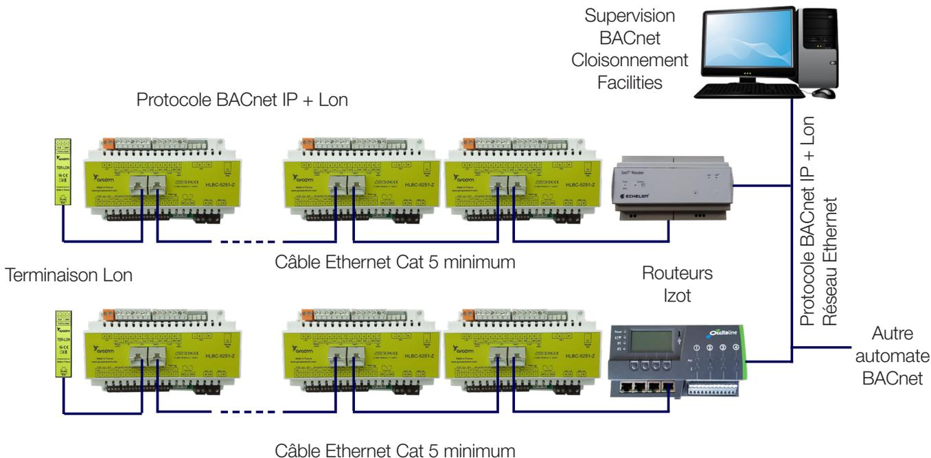
Note : Le réseau BACnet IzoT peut également être câblé en bus 2 fils comme un réseau LonWorks simple.
